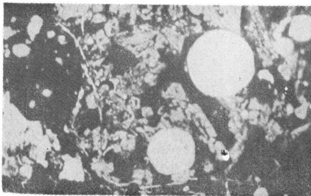
Fig. 2. Zgură neagră-brună, limonitizată, cu cristale microlitice, alungite, de fayalit și de hipersten (alb) și cu incluziuni opace de fer metalic, magnetit și limonit (negru). Conține numeroși pori sferoidali (alb). Porolissum, proba 566. Mărit de 35×.
