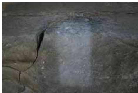
Fig. 5. Test de curățare prin microsablare
