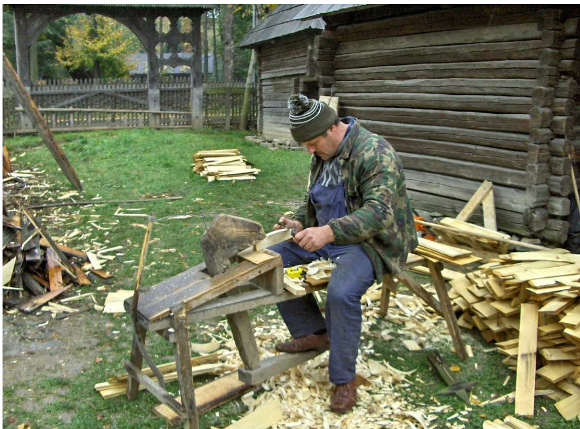
Fig. 8. Trasul șindrilei la cuțitoaie
