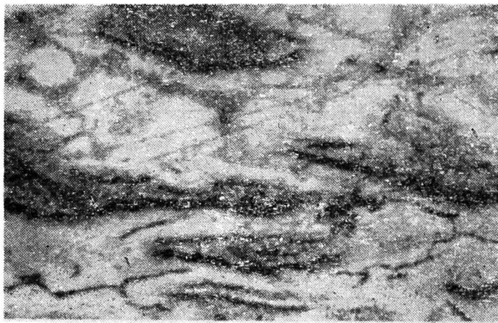
Fig. 6 — Figură de detaliu pentru punere în evidență a compoziției și a stratificării fazelor \alpha și \alpha + \delta . Corodat cu amină cuprică. Mărit de 150\times .
