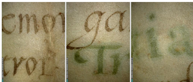
Fig. 6 – Imagini la microscop (20x) cu ilustrarea degradării cernelurilor
