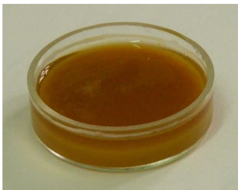
Fig. 3 – Precipitarea din soluție a lacului din Reseda Lutea , obținut experimental (laboratorul CCCR Iași)
