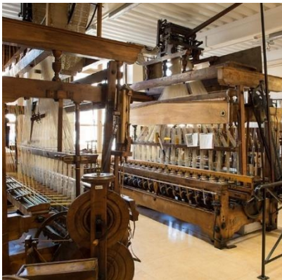
Fig. 19 – Război de țesut pentru țesături înguste, cu mecanism Jacquard (ansamblu și detaliu) [10]
