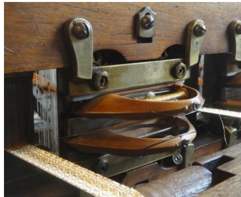
Fig. 19 – Război de țesut pentru țesături înguste, cu mecanism Jacquard (ansamblu și detaliu) [10]
