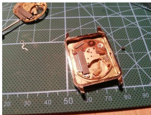
Fig. 5 – Montarea mecanismului reparat
