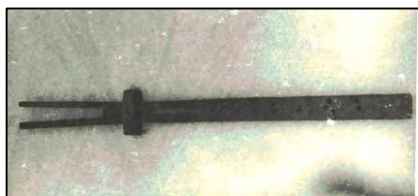
Fig. 14. Șar pentru trasat conturul ciolanelor
