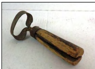
Fig. 10. Scoabă folosită la scobit vasele în interior
