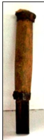
Fig. 8. Bițic, bățic sau bitic de bătut cercurile
