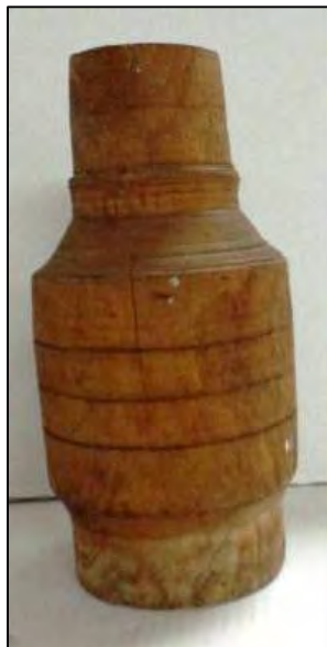
Fig. 13. Măsură „pentru măsurat butucul și dat semne”
