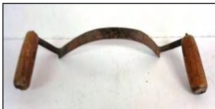
Fig. 12. Cuțitoaie curbă sau teslă de coveți
