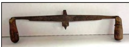
Fig. 16. Cuțitoaie de făcut profile pe scânduri
