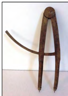
Fig. 17. Compas pentru măsurat roțile de căruță
