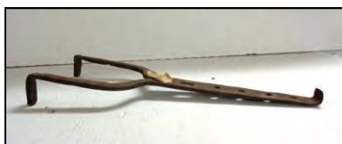
Fig. 26. Potcoavă de tras cercuri la butoaie
