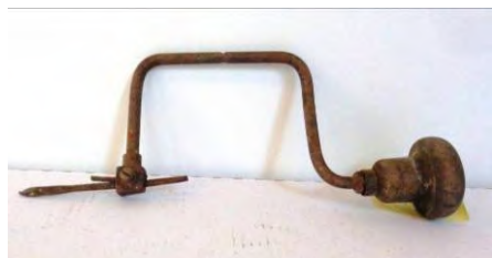
Fig. 25. Coarbă sau curbină de dat găuri
