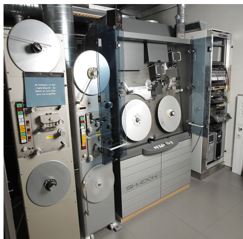
Echipamente profesionale utilizate în digitizarea peliculei cinematografice Telecine Shadow System și Cintel Ursa 444 Telecine
