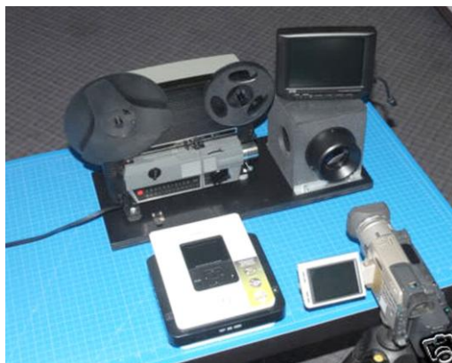
Montajul proiectorului și al camerei video în cazul refilmării prin transparență
