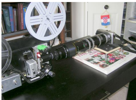
Dispozitive utilizate în digitizarea peliculei cinematografice prin fotografiere sau cu scanner
