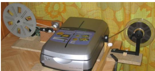
Dispozitive utilizate în digitizarea peliculei cinematografice prin fotografiere sau cu scanner
