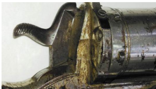
Foto 5. Clapetă cu buton rupt. Înainte de restaurare.
