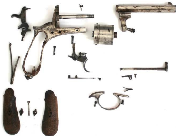
Foto 8. Demontarea pistolului în piese componente. În timpul restaurării.
