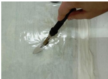
Fig. 10. Călcări calde cu spatula electrică
