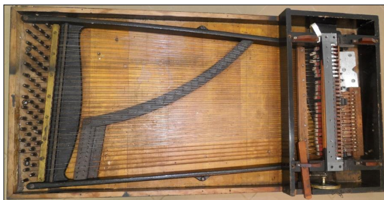
Fig.4. Vedere interioară de ansamblu cu mecanismul pianului
