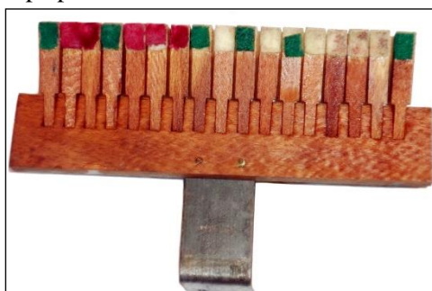
Fig. 11. Reconstituirea integrală a unor ciocănele lipsă
