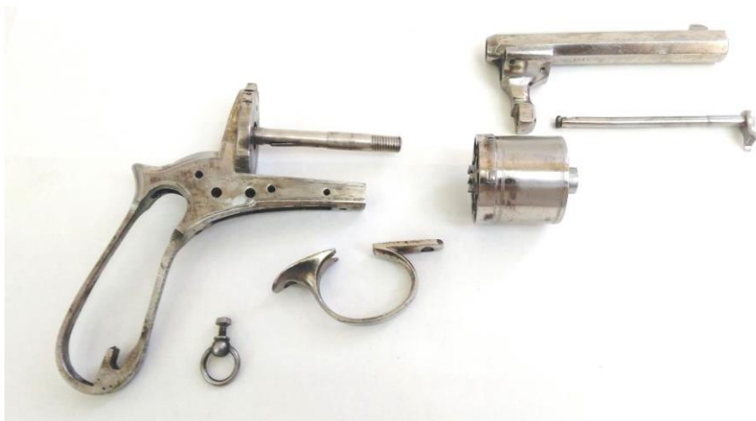
Foto 9. Piesele nichelate tratate cu laser. În timpul restaurării.
