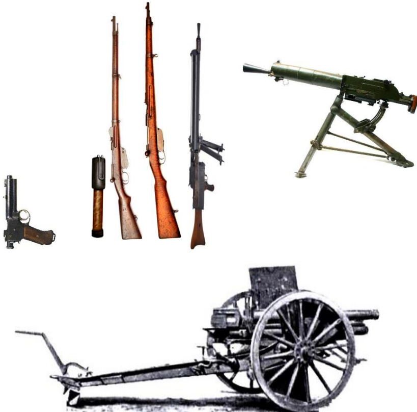
Fig. 3. Armament de proveniență austriacă al unităților ardelenesti: Pistol Steyr-Roth, Stielhandgranatte, Pușcă și Carabină Manlicher md. 1895, Pușcă - mitralieră Maxim 08/15, Mitralieră Schwarzlose md. 1907, Tun de câmp cal. 80 Skoda md. 1905 4
