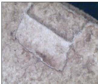
Fragilizarea suportului (ruptură)
