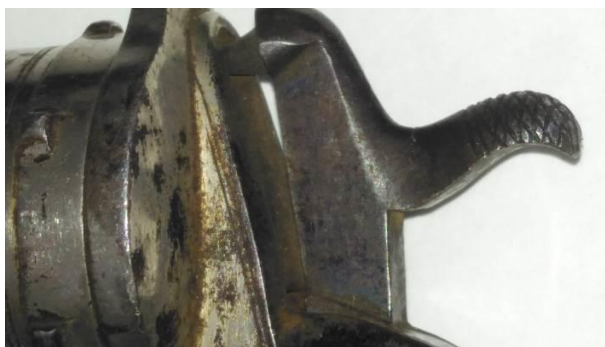
Foto 3. Placare cu nichel și brunare. Înainte de restaurare.
