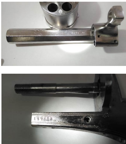
Foto 11. Marcaje poansonate. În timpul restaurării.
