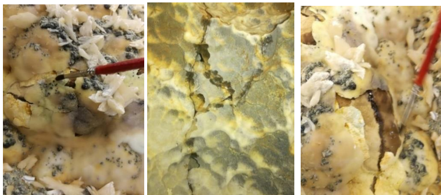
Fig. 30 - 31. Infiltrații repetate cu rășină epoxidică ARALDITE 2020
