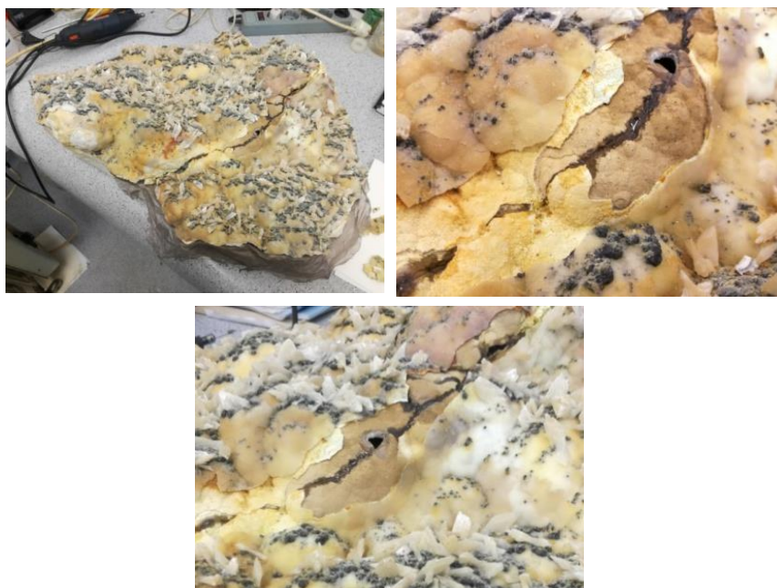
Fig. 27 - 29. Asamblarea cu rășină epoxidică DEVCON
