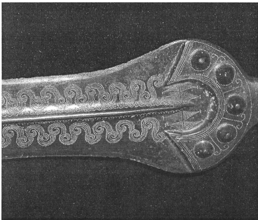
11. Felvétel A 10. Felvételen látható viaszveszejtési eljárással készült kardmásolat részlete az aprólékos diszítéssel
