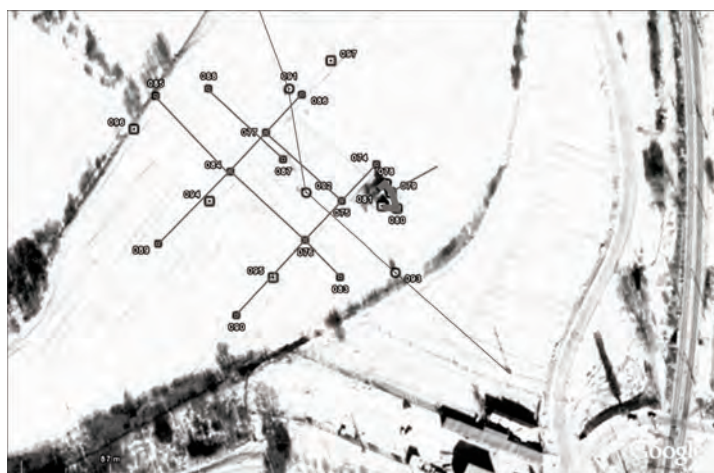
Figura 17 / Figure 17 Traseele măsurătorii de rezistivitate / Resistivity routes measurement.
