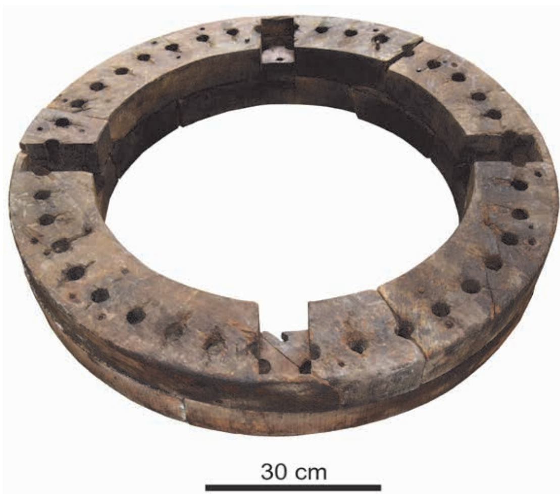
Fig. 8 Roata mășelată a mecanismului morii (foto Florina Bănică). Fig. 8 Cogwheel of the mill mechanism (photo Florina Bănică).
