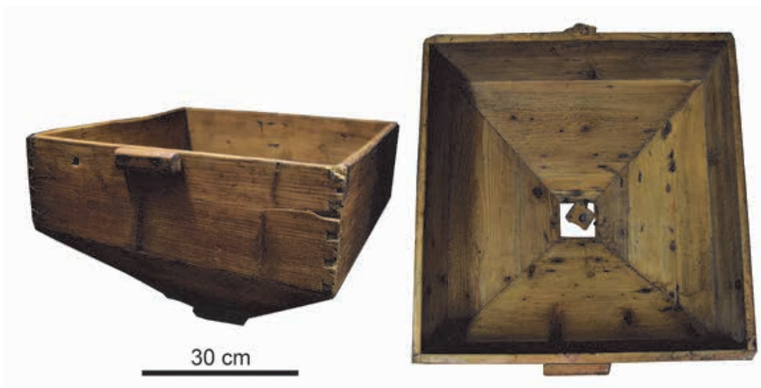
Fig. 14 Coșul de alimentare cu cereale al mecanismului morii (foto Florina Bănică). Fig. 14 Grain feed bin of the milling mechanism (photo Florina Bănică).
