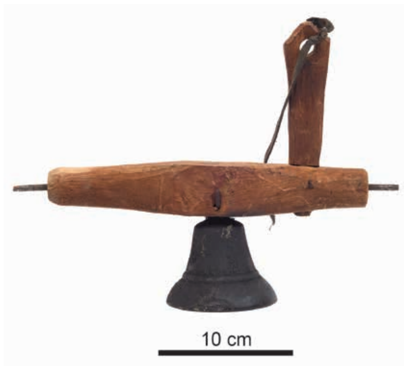
Fig. 23 Clopot de avertizare fixat la ușa de acces în moară (foto Petru Palamar). Fig. 23 Warning bell attached to the access door to the mill (photo credit Petru Palamar).
