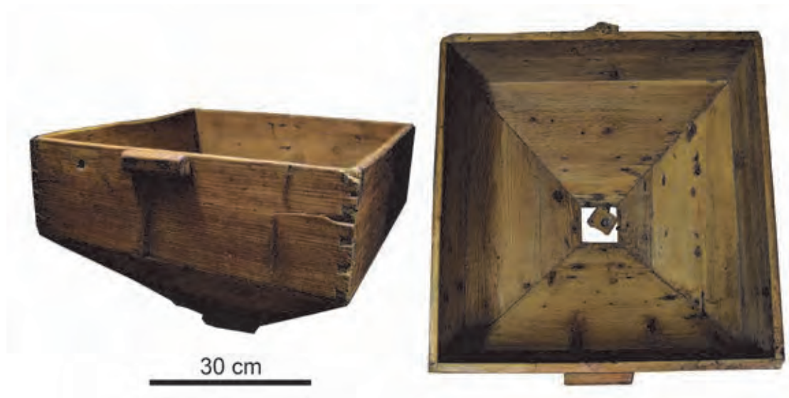
Fig. 14 Coșul de alimentare cu cereale al mecanismului morii (foto Florina Bănică). Fig. 14 Grain feed bin of the milling mechanism (photo Florina Bănică).
