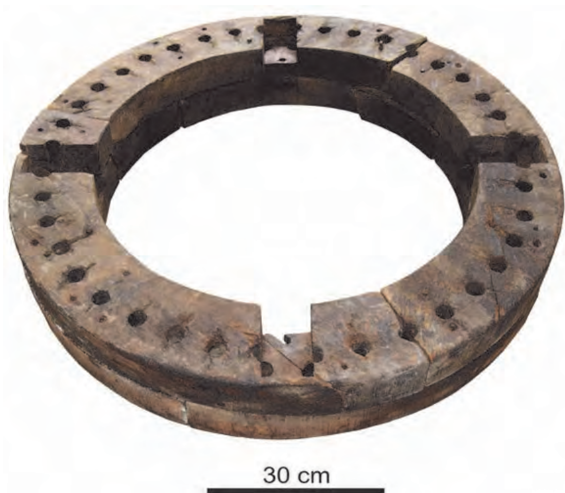
Fig. 8 Roata măselată a mecanismului morii (foto Florina Bănică). Fig. 8 Cogwheel of the mill mechanism (photo Florina Bănică).
