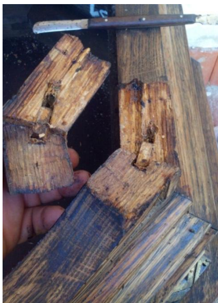
Fig. 5. Unele fracturi existente au fost reîncliate și consolidate cu cepi de bambus.
