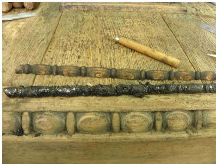
Fig. 4. Soclul - procesul de decapare chimică.
