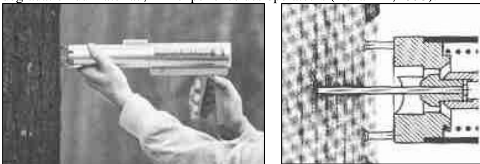
Figure 1 - La méthode d'impact dynamique - équipement et principe ( https://inspectapedia.com/structure/Pilodyn_Wood_Test.php ; 29 sept. 2018).
