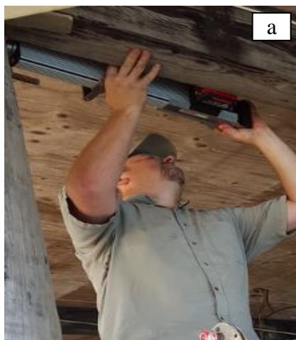
Figure 2 - Essais du bois par la méthode résistographique: a. l'équipement; b. le profil résulté après le test. ( http://www.imlusa.com/html/drilling_resistance_measurement.html/ 29 sept. 2008).
