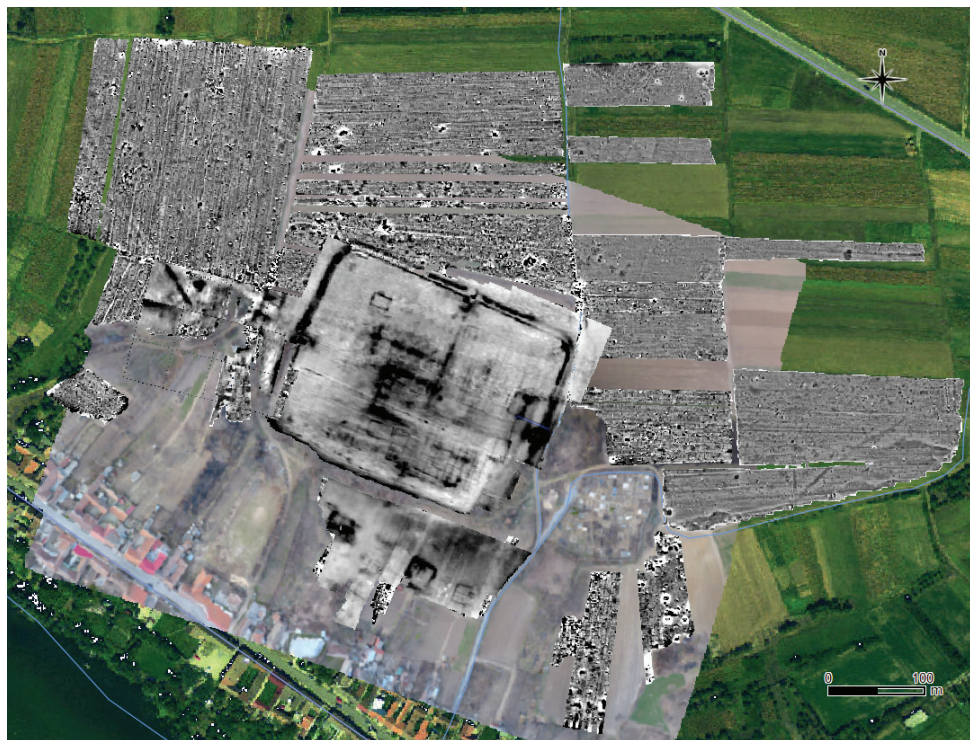
Fig. 4. The whole area of Pojejena surveyed with geophysics – earth resistance and magnetometry (by M. Pisz, E. Jęczmienowski). / Aria Pojejena, rezultatele integrate ale scanării geofizice, rezistivității electrice și a magentometriei (după M. Pisz, E. Jęczmienowski).
