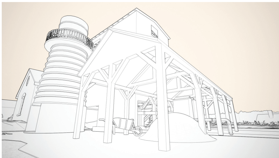
Fig. 6. Vedere reconstituită cu furnalele și turnul de încărcare a primei uzine, cu structura de lemn din fig. 1 în prim plan.
