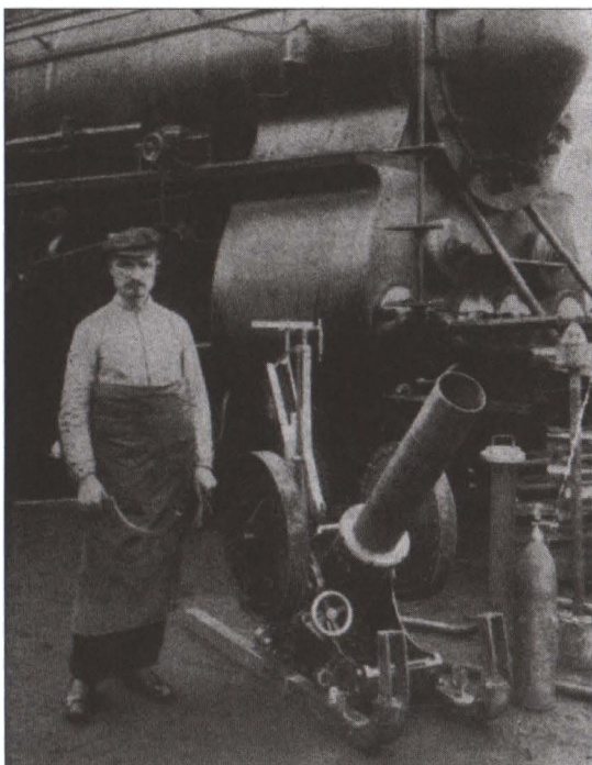
Aruncător de mine de tranșee cal. 155 mm construit în 1915 la Atelierele CFR București
