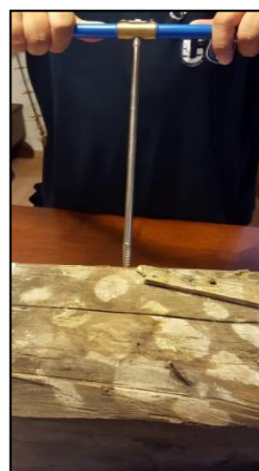
Fig. 9. Prelevarea carotelor de lemn din bârne.
