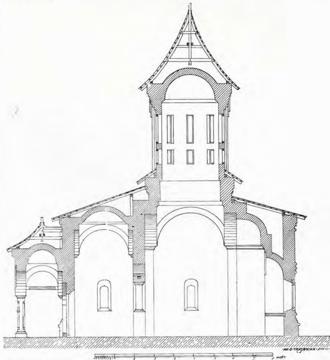
Biserica schitului Sf. Apostoli : secție longitudinală.
