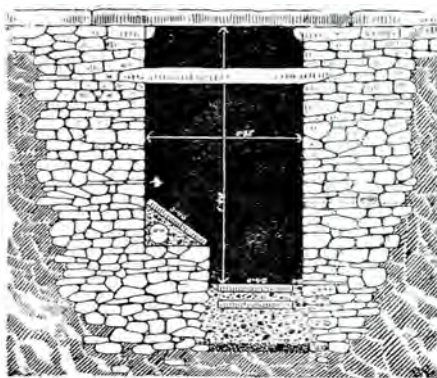
Secțiune prin canalul cetății Tropaeum.
