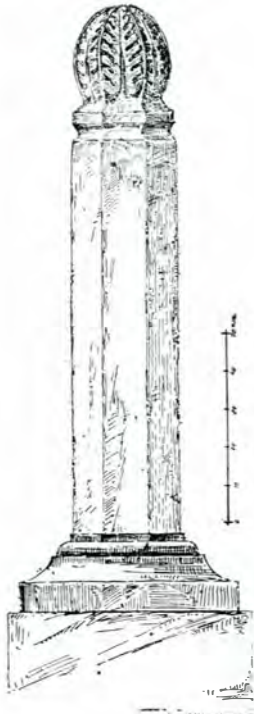
4. Stâlpul de jos dela parapetul scării principale.
