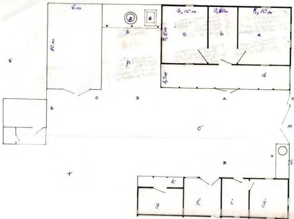
4. Planul general al gospodăriei: A. casa; B. cuptoriște și găbănaș; C. colnă la șură; D. colna de cuptoare; E. cocină de porci și cotețe de păsări; F. fântână cu roată; a. „sobă mare” sau „casa de către uliță”, „camera de goști”; b. tindă; c. „sobă mică”; d. târnaț; e. cuptor de pită; f. „clotan” cu cazan de fiert hrana la porci; g. găbănaș (sau cămară); h. colna de lemne; i. hudă (sau tindă); j. cuptoriștea (sau bucătăria de vară); k. târnaț la găbănaș; l. „vălăul” (jgheabul) de piatră pentru adăpatul vitelor; m. Vramnița (poasta); n. porțița la ocol; o. ocol; p. ocoluț; t. arie pentru nutrețuri; s. grădina de zarzavaturi.
