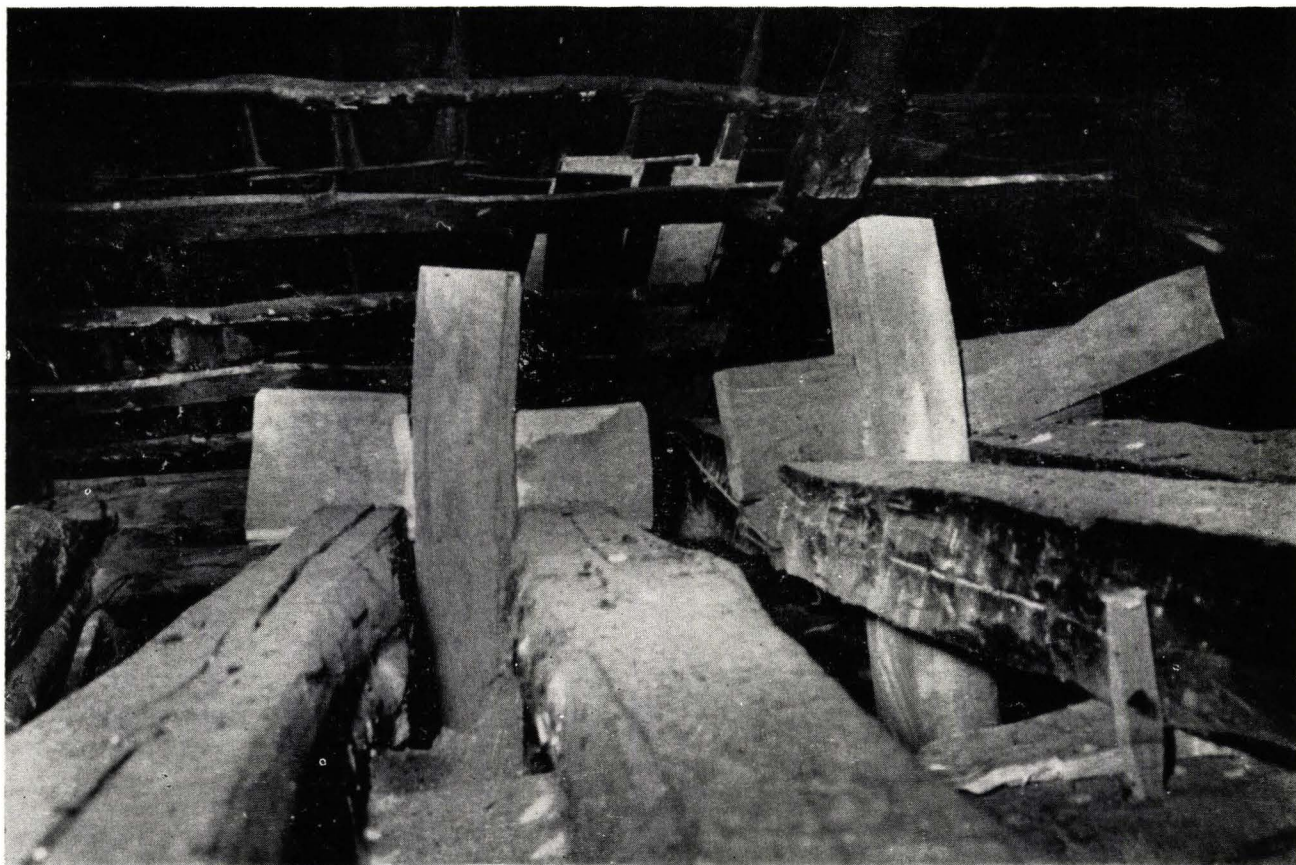
Fig. 5. Sistemul de suspensie a maielor din Piuă de la Prigor, jud. Caraș-Severin.
