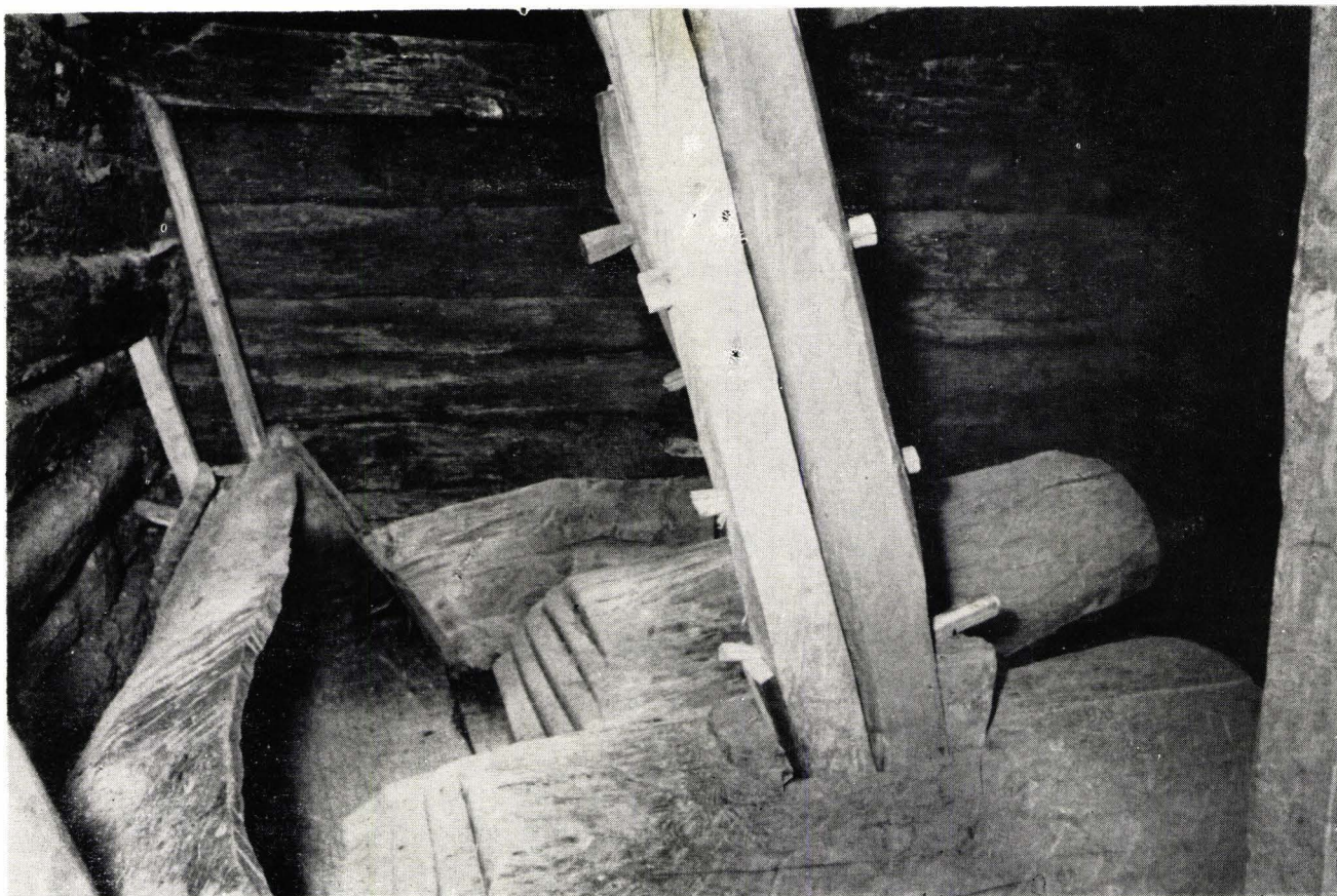
Abb. 3. Waagerecht arbeitende Walkmühle aus Prigor, Kreis Caraș-Severin (Exponat im Museum der bäuerlichen Technik, Sibiu).
