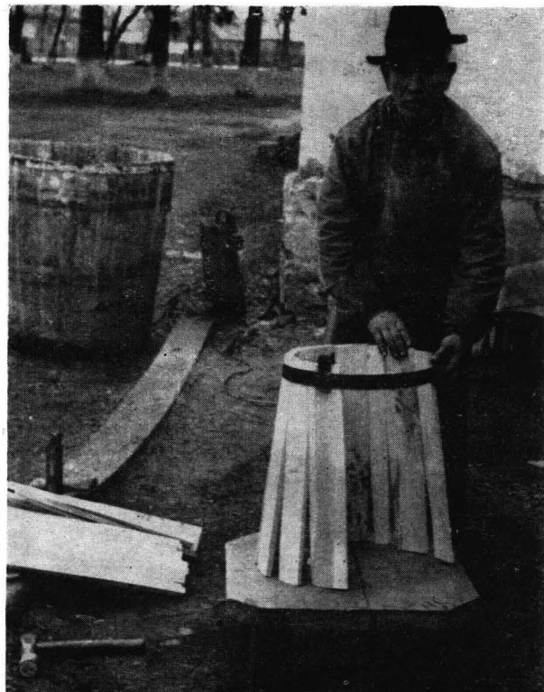
Fig. 11. Montarea mantalei (legarea butoiului pe cerc)
