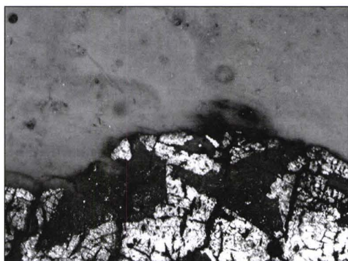
Fig. 15 Imagine obținută cu ajutorul microscopului digital I-scope – foița metalică originală în zona aureolei
