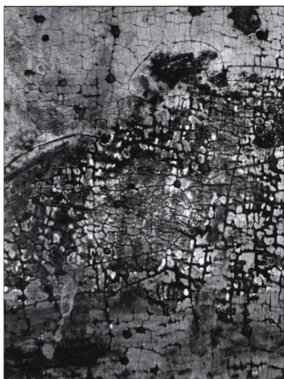
Fig. 12 Detaliu – eroziune la nivelul stratului de culoare cauzată de excremente de păsări
