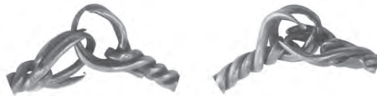
Fig. 3. Detalii asupra uzurii segmentelor de lanț (foto Ovidiu Pascu)
