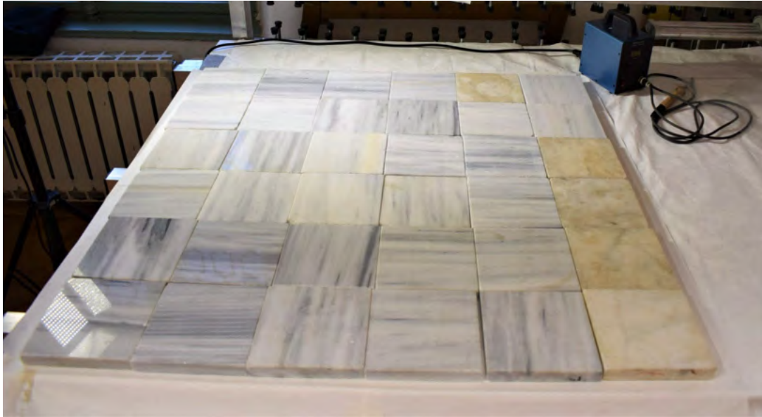
Fig. 12. Planeitatea suportului, obținută cu ajutorul preselor de marmură
