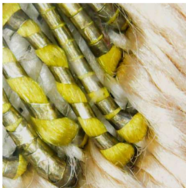
Degradarea firelor metalice (imagine la microscop)
