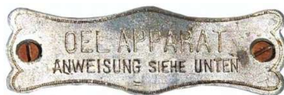
Fig. 2. Plăcuță metalică, acoperitoare a orificiului de ungere, amplasată deasupra axului manivelei
