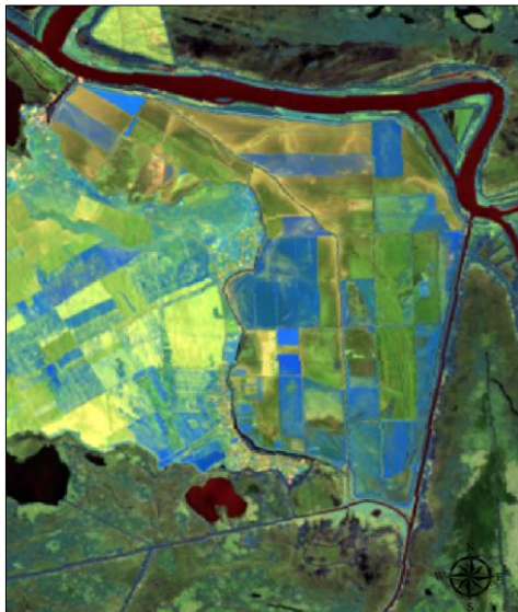
Fig. 7. Imagini satelitare Landsat 8 (combinarea benzilor 4, 6 și 5 – soluri și sedimente) Figure 7. Landsat 8 satellite imagery (combination of bands 4, 6 and 5 – soils and sediments)
