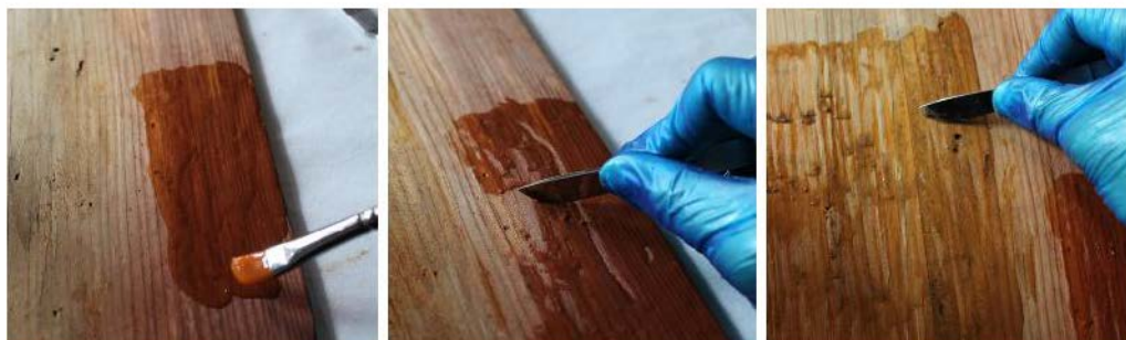
Fig. 9. Curățirea suportului de lemn cu soluție de metilceluloză.
