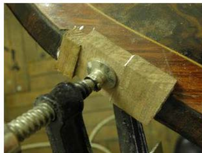
Fig. 36 și 37. Completări cu lemn.
