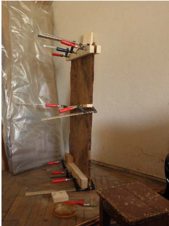
Fig. 34 și 35. Presarea blaturilor în vederea rectificării planității.
