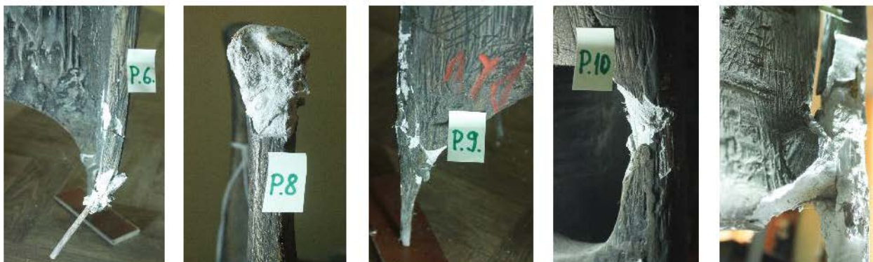
Fig. 10-14. Etape de cercetare (fracturi, dislocări, armături metalice îndoite).
