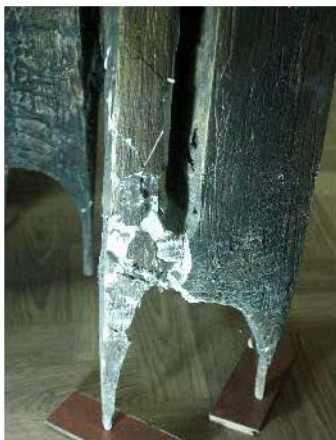
Fig. 2 și 3. Etape de cercetare (fracturi, dislocări, armături metalice îndoite).
