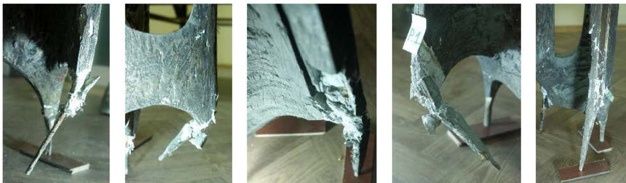
Fig. 5-9. Etape de cercetare (fracturi, dislocări, armături metalice îndoite).
