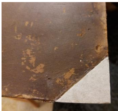
Fig. 8. Imagine de detaliu realizată după reconstituirea colțului lipsă.
