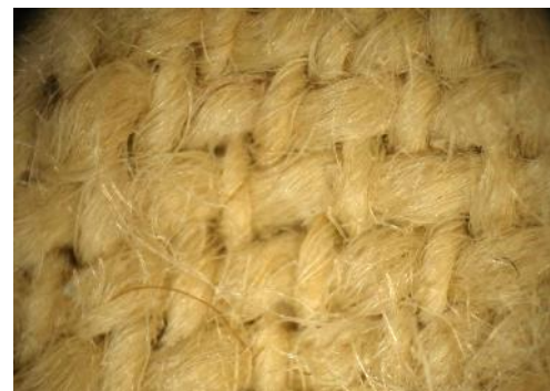
Fig. 4. Țesătură legătura diagonal 1/2, cu aspect de băteală, detaliu stereo x.
