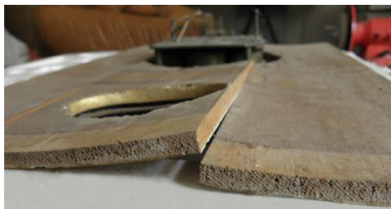
Fig. 9. Modificări de planeitate între elementele panoului frontal.
