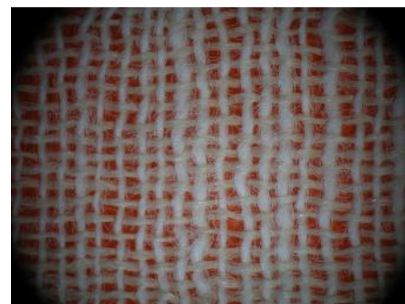
Fig. 3. Țesătură în 2 ițe - legătură fundamental pânză.
