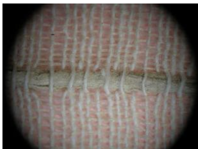
Fig. 7. Defect de toarcere - acumulare de fibre.
