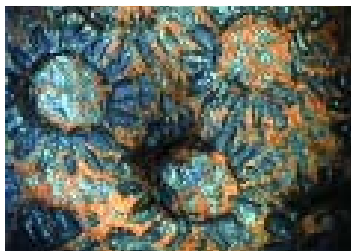
5. kép. Az ezüstözött szegély rendkívül kopott állapota. Mikroszkópos felvétel
