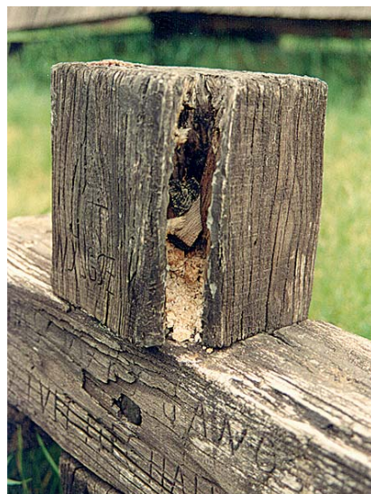
8. kép. Faodvasító lóhangya kártétele
