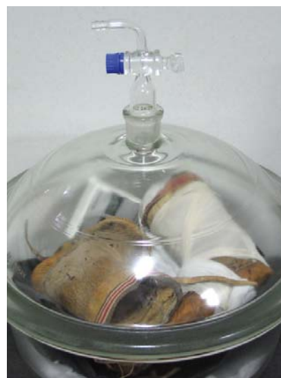
19. kép. Nedvesítés sóoldattal beállított, ellenőrzött páratartalmú zárt térben.
