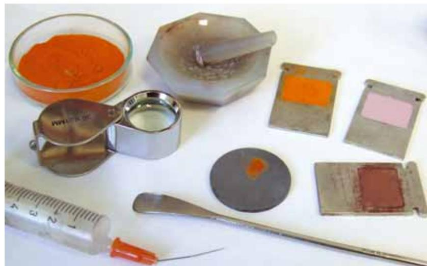
3. kép. Mintakészítés: hagyományosan előkészített préselt porminták és alacsony-háttérű mintattartóra főlkent mg-os mennyiségű minta.
