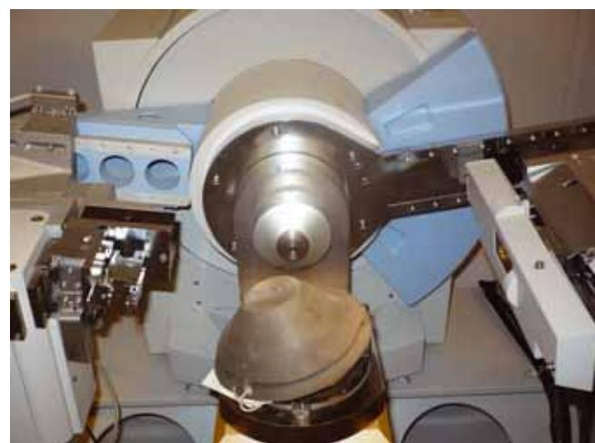
2. kép. Egyes diffrakrométerekben nagyobb műtárgyak is vizsgálhatók.
