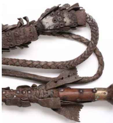
5. kép. A szilárd zsírsavak fehér zsírkiütés formájában jelennek meg a bőrtárgyak felületén, különösen hűvös körülmények között. (Karikás ostor, Néprajzi Múzeum, Budapest)
