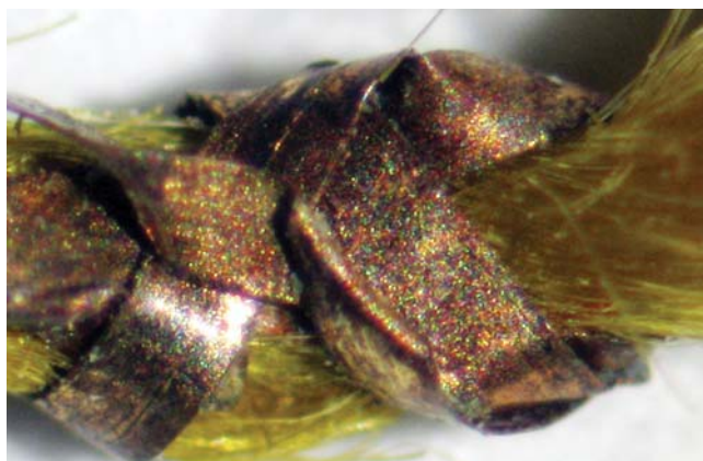
11. kép. Matt aranyt látszó, ezüstözött-aranyozott vörösrézről készült fonál.
