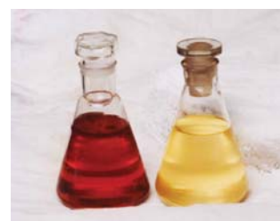
4. kép. A 3. képen látható dudu bőrből szerves oldószerekkel kioldott zsíradék és szennyeződés (első és második fürdő).
