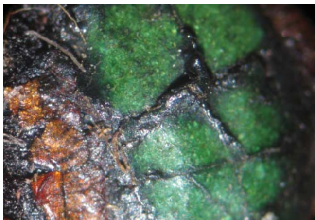
7. kép. Az eredetileg szilárd zöld pigment a zsírsavak hatására lágy állagú réz-sztearáttá és réz-palmitáttá alakult át. (Aranyozott, festett miseruha részlete mikroszkóp alatt, Iparművészeti Múzeum, Budapest.)
