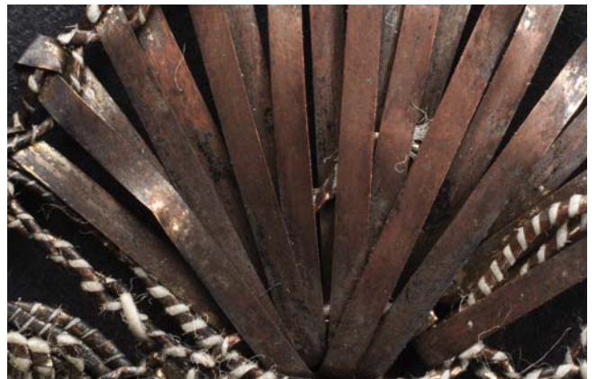
4. kép. Ezüstözött rézfonalból készült csipke és annak részlete, illetve ugyanez a csipke részleges tisztítás után. Az ezüsttisztító szer (savas tiokarbamidat, Argentol) leoldotta a fekete korróziós terméké alakult ezüstreget – előtűnt a vörösréz alapfém. A tisztítással fontos készítéstechnikai információk veszhetnek el.
