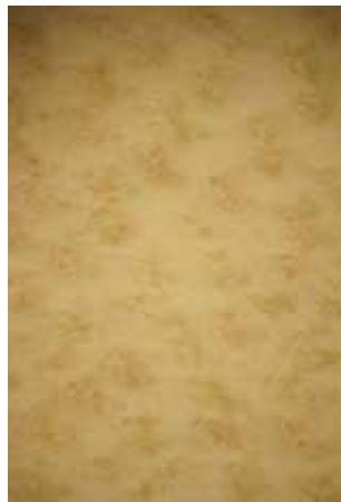
3. kép. Kecskebőrök készült pergamen barkaoldalának mikroszkópos felvétele.
