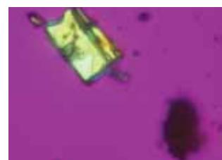
19–20. kép. Auripigment, átmenő fényben és érzékeny ibolya segédlemezzel: lapos, szögletes, jól hasadó szemcse, erős kettőstöréssel.
