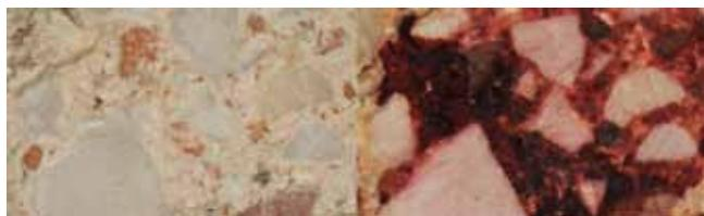
9. kép. A nucleus felső rétegből származó minta Alizarin vörös S kezelés után. A vizsgálat alkalmas a kalcit és a dolomit elkülönítéséhez.
